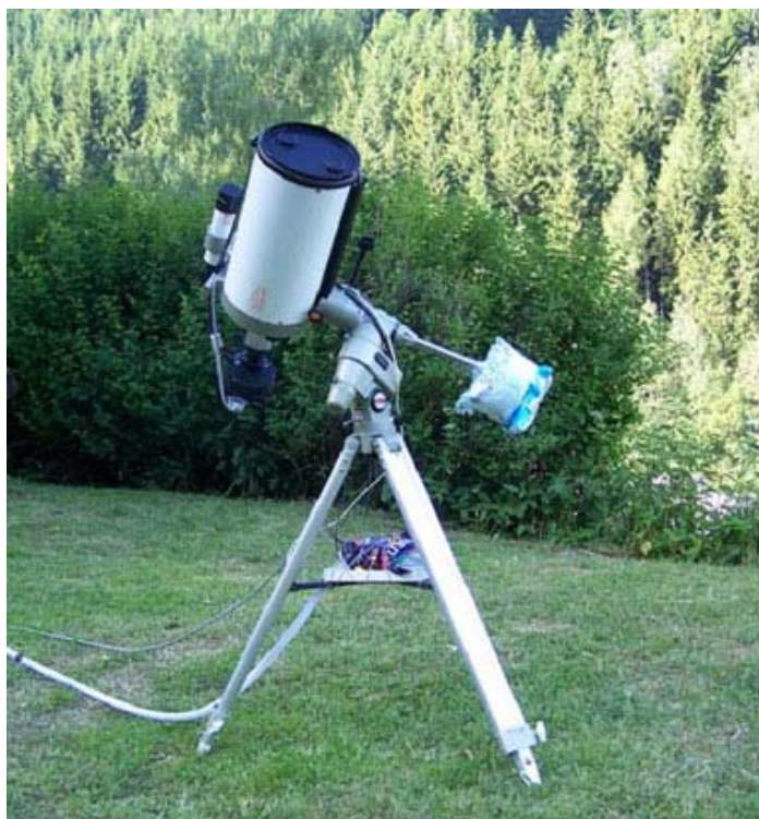
Obr. 2: Hlavní dalekohled catadioptrický cassegrain Vixen VC200L+ CCD SBIG ST8 Pic 2: Main telescope of ALTAN.Observatory – catadioptric cassegrain Vixen VC200L + CCD SBIG ST8
